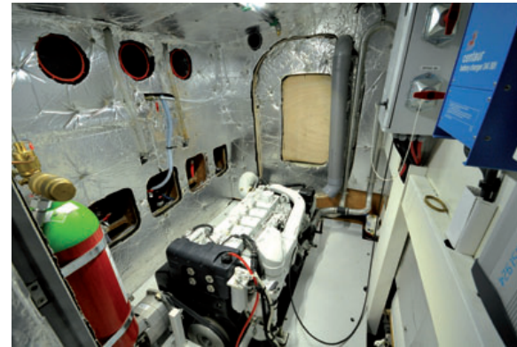
La salle machine dotée de caméras, pour avoir toujours un œil sur les moteurs du poste de barre...
