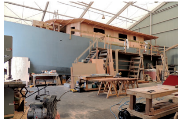
Le choix du CP stratifié verre époxy s'est logiquement imposé pour la construction d'Etoile 65...
