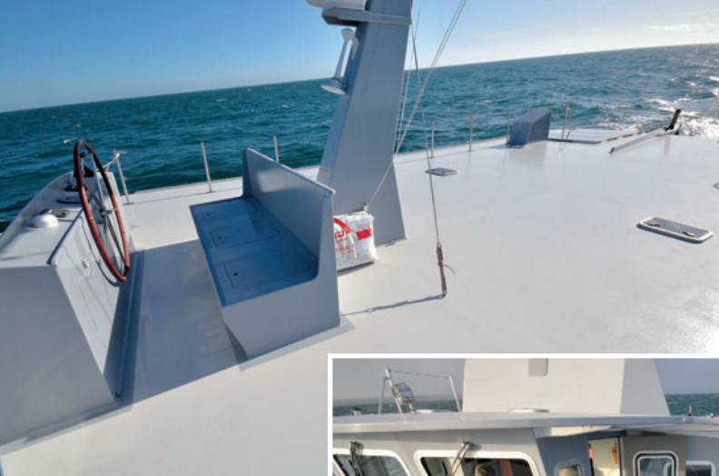
Pour les navigations par beau temps ou pour naviguer dans le corail, Etoile 65 est pourvu d'une poste de barre sur le flybridge.
